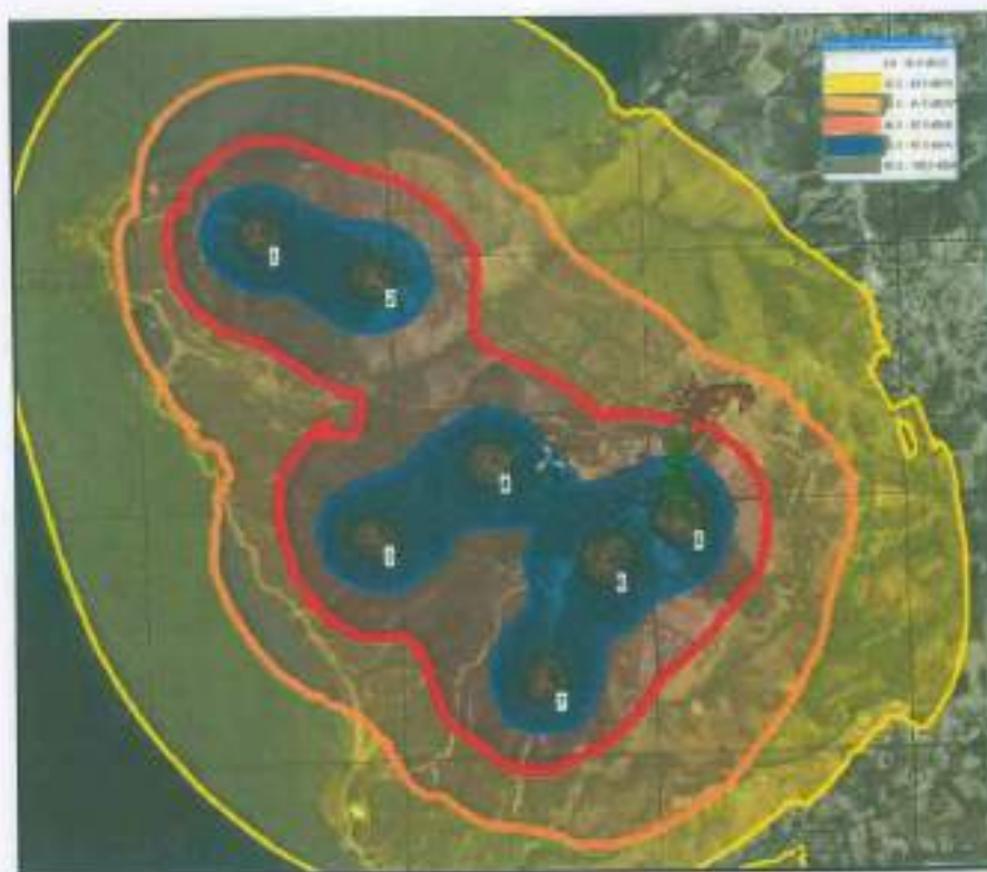
Figura 6: Harta e përhapjes së zhurmës së aerogjeneratorëve
