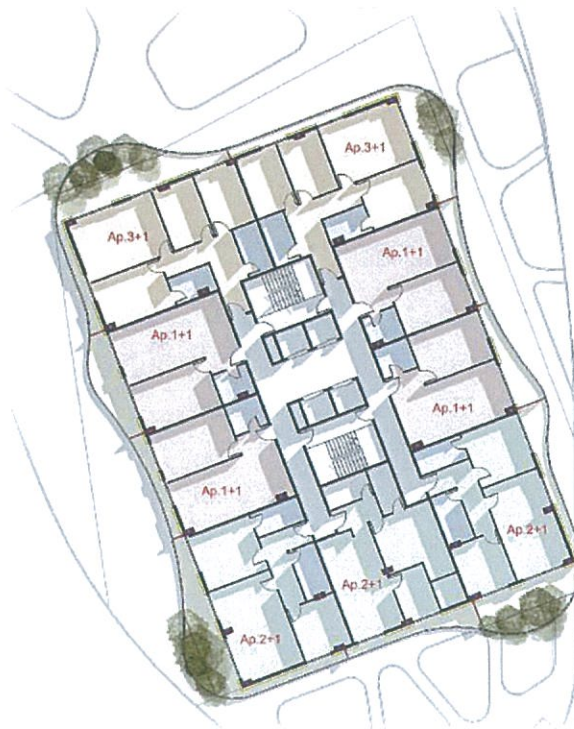
Fig. 10. Planimetria e katit tip
