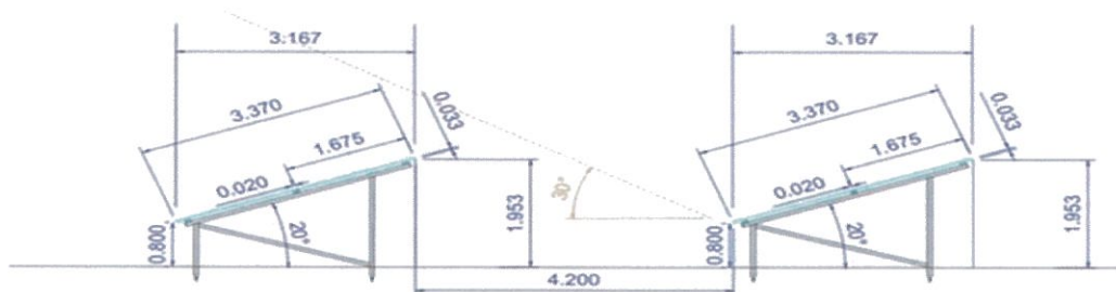
Figura: Pamja anësore – mbajtëses së paneleve
