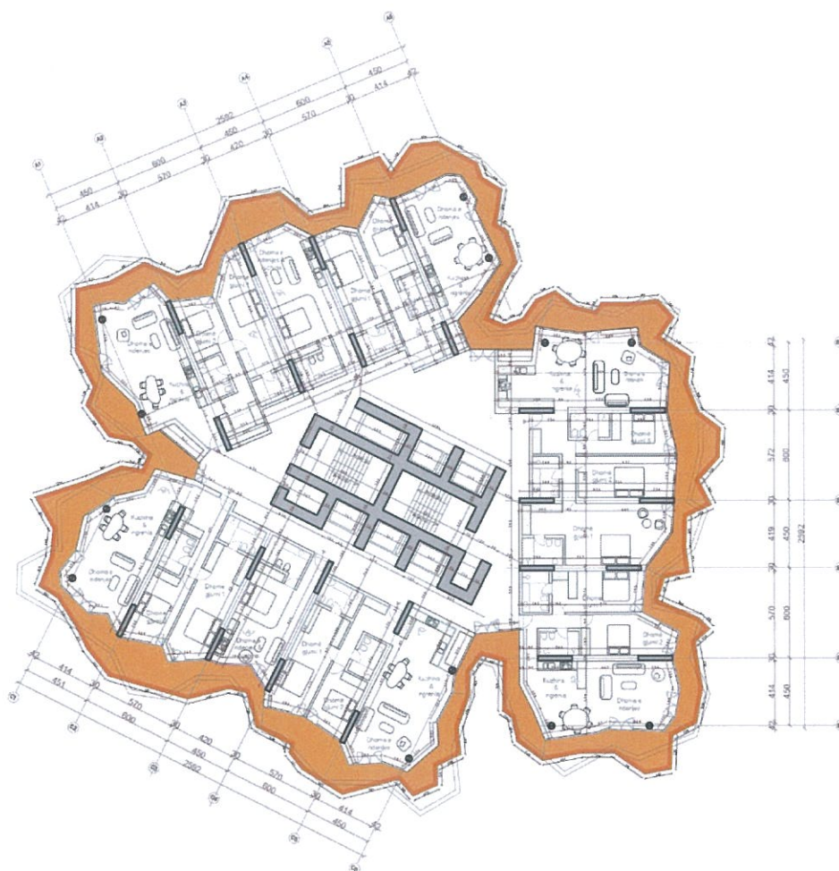
Fig. 14 – Kati i katërt, Kati i pestë, Kati i nëntë, Kati i dymbëdhjetë, Kati i trembëdhjetë, Kati i pesëmbëdhjetë, Kati i gjashtëmbëdhjetë, Kati i njëzet, Kati i njëzet e katërt, kuota +14.00m, +30.00m, +39.60m, +42.80m, +49.20m, +52.40m, +65.20m, +78.00m.
